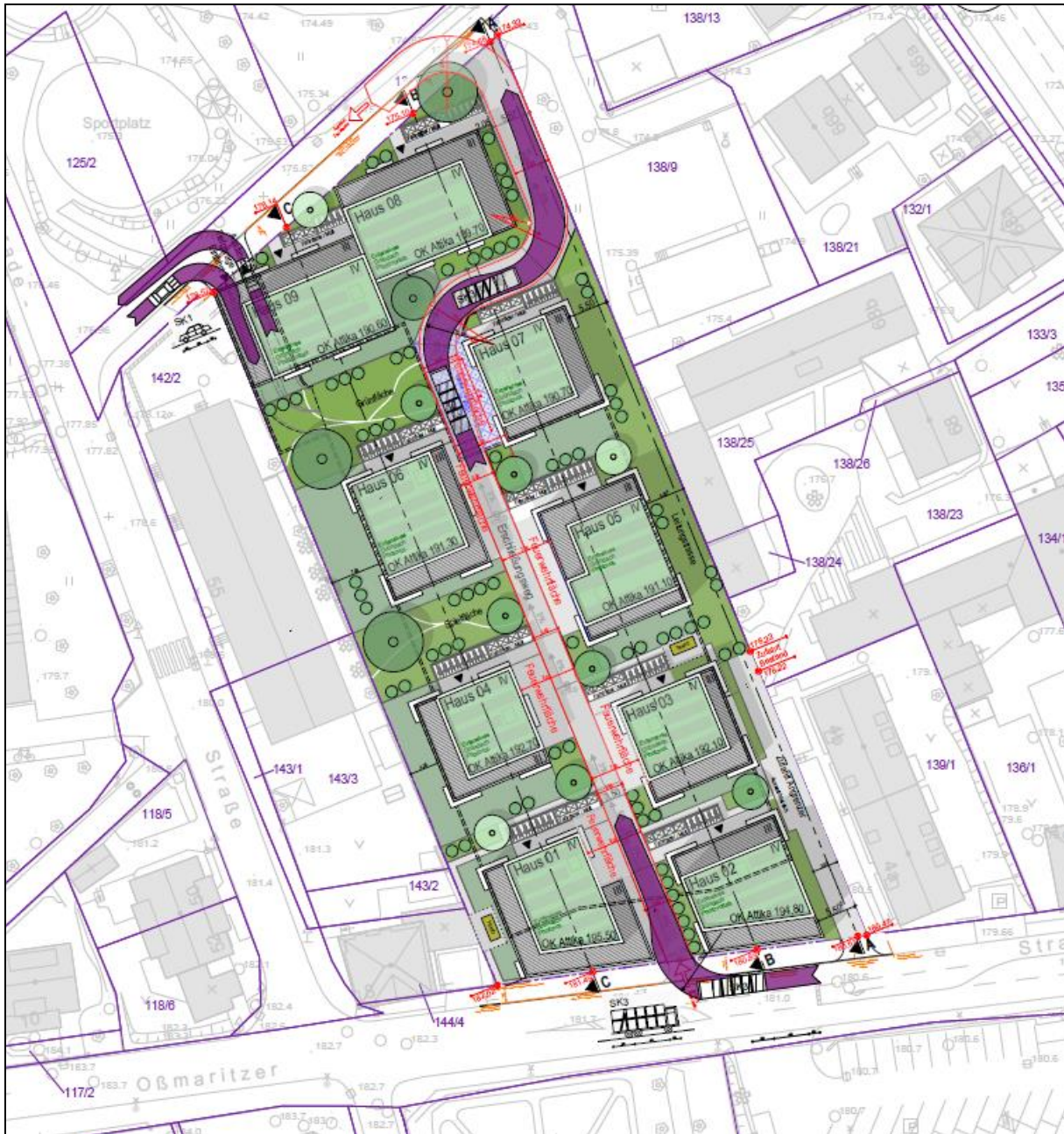
Abb. 4: Lageplan mit Fahrweg und Schleppkurven für ein dreiaxsiges Müllfahrzeug, für Pkw (Quelle: Bramey und Partner, Vorhaben- und Erschließungsplan, Stand 19.08.2024)
