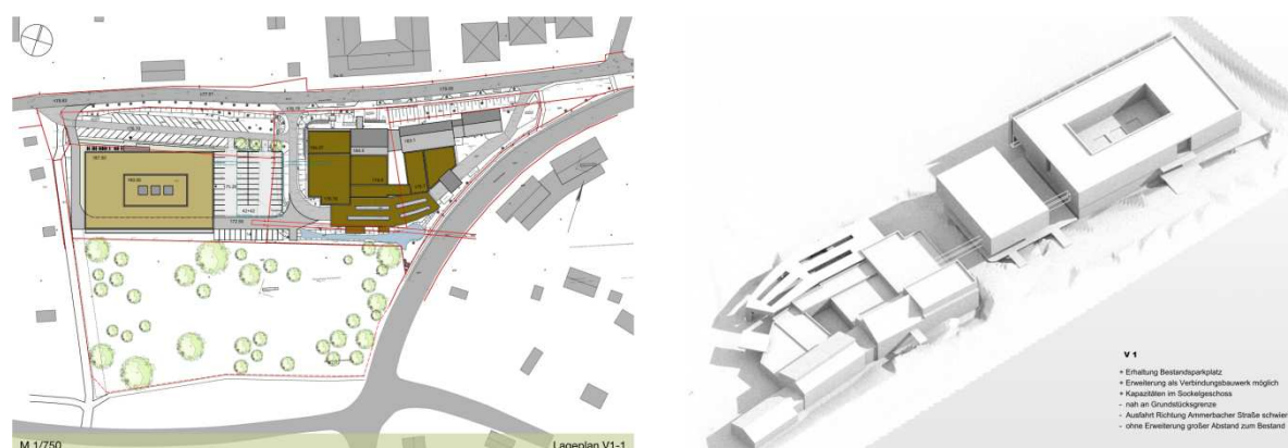
Abbildung 5: Variante 1.1 mit Anordnung im südwestlichen Baugebietsbereich mit zwischengelagertem 2-geschossigen Parkdeck und möglicher Erweiterung im Bereich des Parkdecks.
