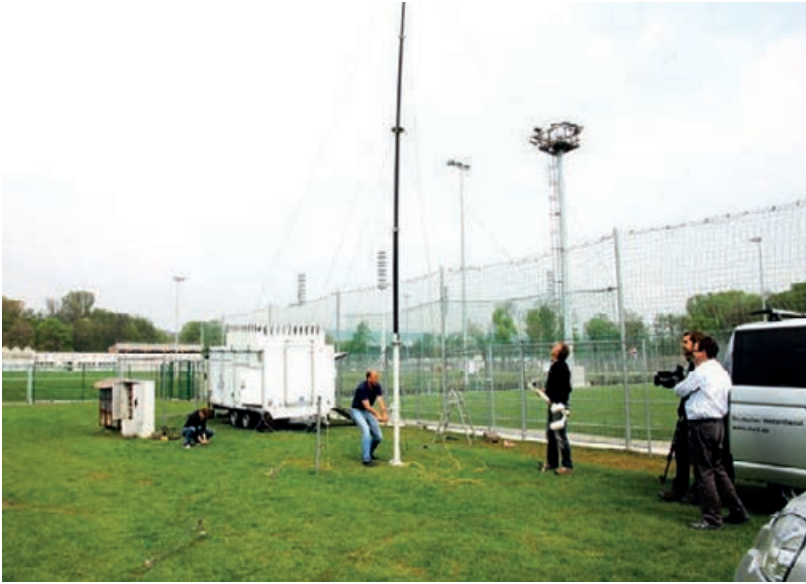
Abbildung 3.6: Errichtung einer temporären Messstation in der Saaleaue durch den DWD (Quelle: Maercker 2011)
