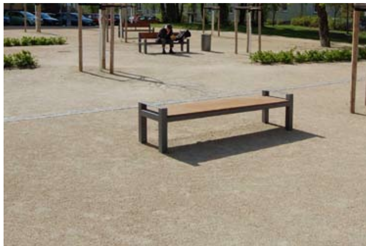
Wassergebundene Wegedecken vermeiden eine harte Wirkung der Oberfläche und erhöhen die Standortqualität für Bäume
